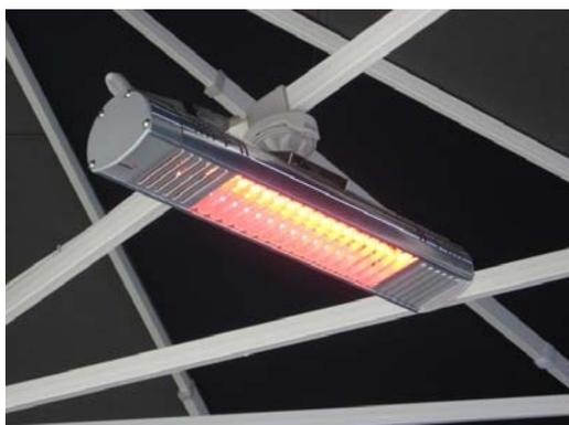
Vor dem Einschalten des Heizstrahles muss dieser in horizontale Lage gedreht werden, sonst wird die Lebensdauer der Heizröhre verkürzt.
