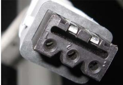
f Monter la partie du connecteur dont les contacts sont protégés (STAK3) sur le côté alimentation.
