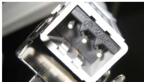
Steckerhälfte mit den offenen Kontakten (STAS3) auf der Heizstrahlerseite montieren. Sicherungsbügel einschnappen.
