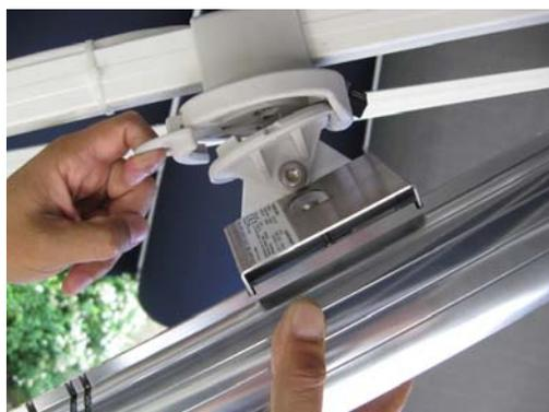
Tenir l'unité de transmission de chaleur d'une main et de l'autre main tirer l'anneau de commande du raccord rapide. Après avoir tiré l'anneau de commande, ôter la bride d'accouplement du raccord rapide en l'inclinant et retirer l'unité de transmission de chaleur. Prudence: ne pas laisser tomber l'unité de transmission de chaleur.
