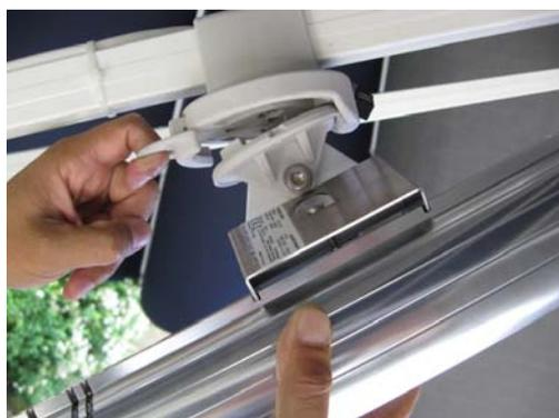
Tenere l'emittente di calore con una mano e con l'altra tirare l'anello di manovra sull'attacco rapido. Con l'anello di manovra tirato piegare la flangia di attacco fuori dall'attacco rapido e rimuovere l'emittente di calore.
