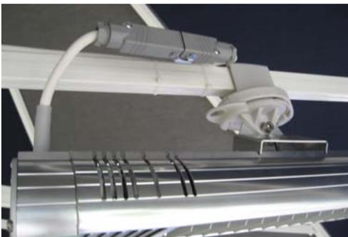
Kabel im Bereich des Heizstrahlers mit Kabelbindern sichern, sodass die mögliche Schwenkbewegung nicht behindert wird. Der Heizstrahler kann 90° in der Schnellkupplung gedreht werden.
