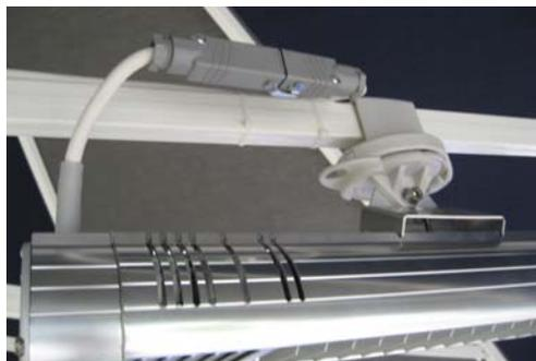
Fermare i cavi in prossimità dell'emittente di calore tramite fascette ferma cavi, in modo da non impedire un possibile movimento oscillatorio. L'emittente di calore può essere ruotata di 90° con l'attacco rapido.
