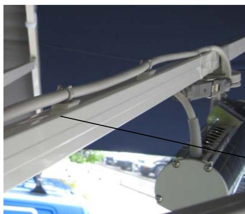
Applicare i portacavo alle stecche dell'ombrellone in modo che il passaggio del cavo risulti „pulito“ con l'ombrellone aperto. I portacavo sono costruiti in modo tale che il cavo scorra lungo i supporti in caso di carico a trazione, come avviene al momento di chiudere l'ombrellone.
