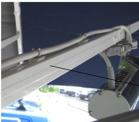
Fixer les supports de câble sur les baleines de manière à ce que le câble soit parfaitement positionné lorsque le parasol est ouvert. Les supports de câble ont été conçus de manière à extraire le câble des supports en tirant, ce qui peut se produire lors de la fermeture du parasol.
